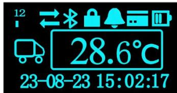
第一屏产品主界面显示信号强度、平台通讯状态、蓝牙状态、按键锁状态、报警状态、电池电量、监控状态、温度数值、运行时间等信息。
